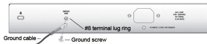
Figura 6. Collegamento di un cavo di messa a terra
