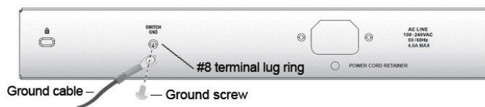
Figure 6. Branchement d'un câble de mise à la terre
